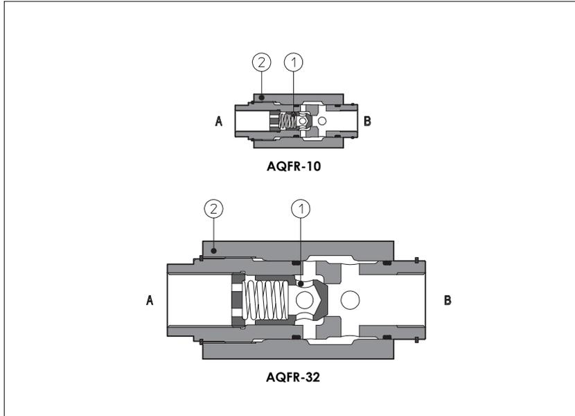
AQFR - некомпенсационные клапаны ограничения потока со встроенным обратным клапаном (1) для прохождения потока в противоположном направлении.
