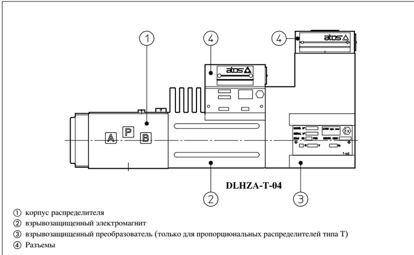
Взрывозащищенные переключающие и пропорциональные электромагниты сертифицированы в соответствии со стандартом АТЕХ 94/4/CE:
